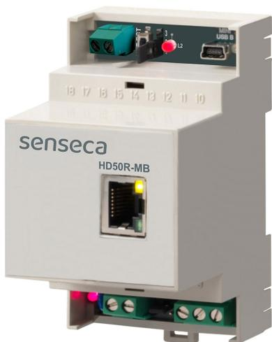
Data logger con interfaccia **Master RS485 Modbus RTU** per l'acquisizione di sensori con uscita RS485 Modbus RTU (ad esempio un anemometro della serie HD52.3D...). Un ingresso a contatto a potenziale libero permette di collegare un pluviometro con uscita a contatto.
