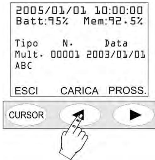
Per ogni file sono indicati: il tipo di file (se singolo, multiplo o automatico), il numero progressivo assegnato dallo strumento al momento della memorizzazione e la data. Per passare al file successivo premere il tasto PROSS., per caricare il file corrente premere CARICA.
