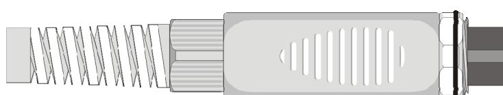
Di seguito vengono fornite le istruzioni per la connessione della sonda al Platino o al Nichel al modulo. Il modulo viene fornito completo di passacavo e gommino per cavi di diametro massimo pari a 5mm. Per aprire il modulo e poter connettere una sonda, si opera come segue.
