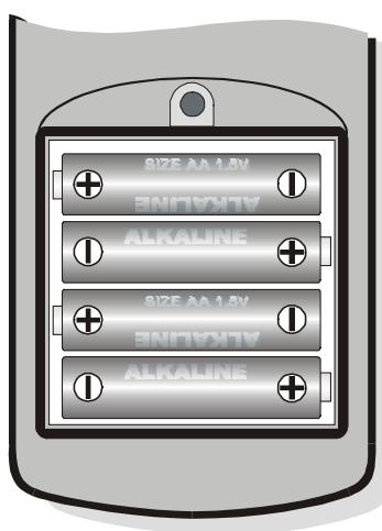
**Dopo il cambio batteria, vanno reimpostati** la data, l'ora, il baud rate, il tipo di sonda, l'intervallo di stampa, i parametri di logging: **per semplificare l'operazione, all'inserimento delle nuove batterie lo strumento si accende automaticamente e richiede di seguito tutti questi parametri.** Per
