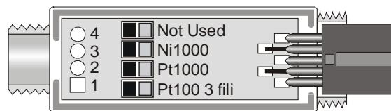
Prima di effettuare le saldature far passare il cavo della sonda attraverso il passacavo e il gommino. Saldare i fili come riportato nella tabella:
