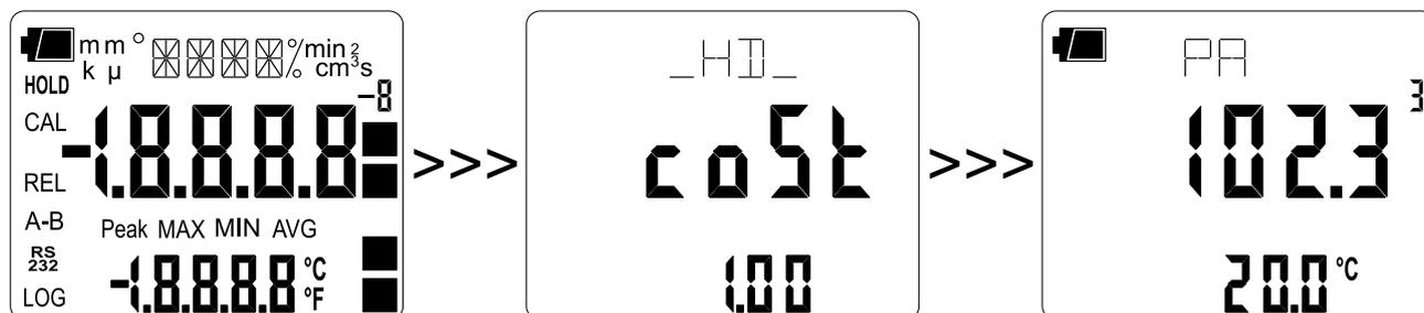
Se all'ingresso non è collegata una sonda a termocoppia, la temperatura di compensazione, visualizzata nella riga secondaria, è quella manuale. Il valore di default è 25°C.
