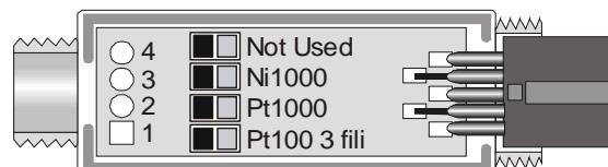
Prima di effettuare le saldature far passare il cavo della sonda attraverso il passacavo e il gommino. Saldare i fili come riportato nella tabella:
