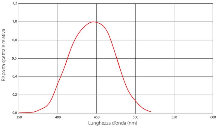
La sonda radiometrica **LP471BLUE** misura l'irradiazione (W/m<sup>2</sup>) nella banda spettrale della luce blu. La sonda è composta da un fotodiode più un opportuno filtro ed è provvista di diffusore per la corretta misura secondo la legge del coseno.
