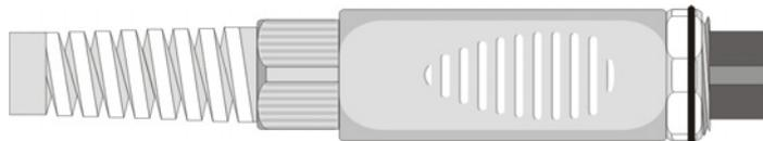
Di seguito vengono fornite le istruzioni per la connessione della sonda al Platino al modulo TP47. Il modulo **TP47** viene fornito completo di passacavo e gommino per cavi di diametro massimo pari a 5mm. Per aprire il modulo e poter connettere una sonda, procedere nel modo seguente:
