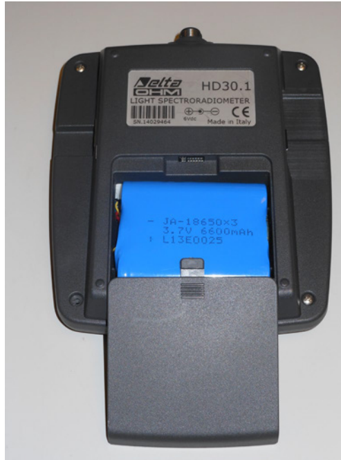
Figure 2.1: batteria non collegata all'interno del vano batteria.
