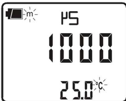
Per variare manualmente la temperatura di compensazione premere una volta il tasto °C/°F: il valore della temperatura indicata inizia a lampeggiare. Con le frecce impostare il valore di temperatura della soluzione e confermare premendo ENTER. Il display cessa di lampeggiare e la temperatura presente a display è utilizzata per la compensazione.
