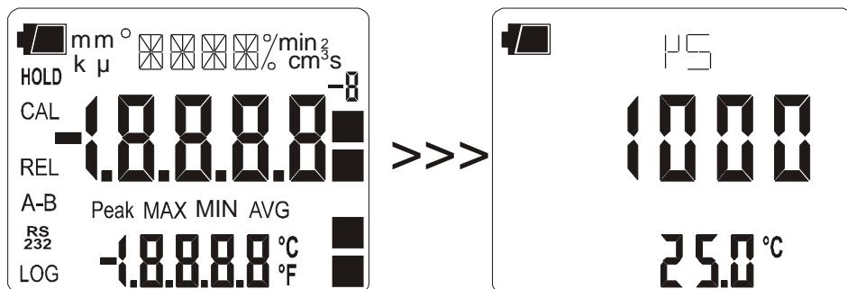
Se all'accensione non vi sono sonde di temperatura collegate, nella riga secondaria appare il valore dell'ultima temperatura impostata manualmente. Il simbolo dell'unità di misura ( $^{\circ}\text{C}$  o  $^{\circ}\text{F}$ ) lampeggia e una lettera "m" che sta per "manual" si accende di fianco al simbolo di batteria.
