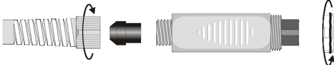
Aprire i due gusci del modulo: al suo interno è alloggiato un circuito stampato al quale si dovrà collegare la sonda di temperatura. I fili provenienti dalla cella di conducibilità vanno saldati **direttamente** sui pin 1 - 2 - 4 - 5 del connettore.
