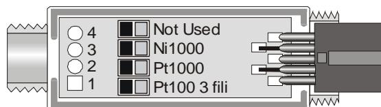
Prima di effettuare le saldature far passare il cavo della sonda attraverso il passacavo e il gommino. Saldare i fili del sensore di temperatura come riportato nella tabella:
