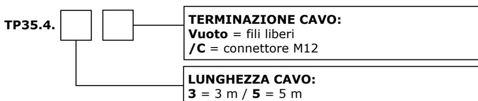
**TP35878.3** Sonda di temperatura a contatto per pannello fotovoltaico. **Pt100** classe B a tre fili. Temperatura operativa: -40...+150 °C. Piastrina in alluminio adesiva 10 x 30 x 5 mm. Cavo isolato TPE. Lunghezza cavo 3 m. Terminazione cavo con connettore M12 a 4 poli.
