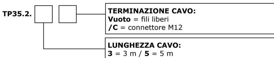
**TP35.4...** Sonda di temperatura **Pt100** 1/3 DIN a quattro fili. Temperatura operativa: -50...+105 °C. Tubetto  $\varnothing 6 \times 50$  mm in acciaio inox AISI 316. Lunghezza cavo 3 o 5 m standard. Terminazione cavo con fili liberi o connettore M12 a 4 poli.
