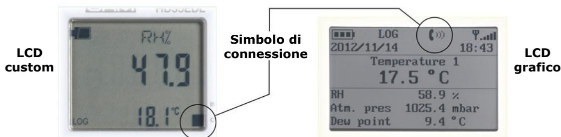
**Fig. 3.4: simbolo di connessione nel display**
