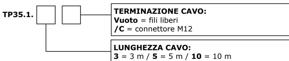
**TP35.2...** Sonda di temperatura **Pt1000** 1/3 DIN a quattro fili. Temperatura operativa: -40...+105 °C. Tubetto  $\varnothing 5 \times 20$  mm in gomma termoplastica. Lunghezza cavo 3 o 5 m standard. Terminazione cavo con fili liberi o connettore M12 a 4 poli. Adatta anche per impiego con soluzioni chimicamente aggressive.
