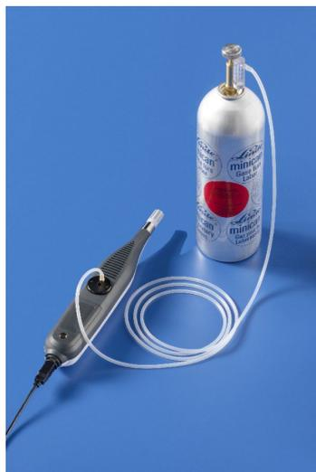
3. Per la calibrazione a 0 ppm, dopo aver collegato all'ingresso CO<sub>2</sub> dello strumento il tubetto proveniente dalla bombola di azoto, regolare il flussometro della bombola per avere un flusso costante compreso tra 0,3 e 0,5 l/min.
