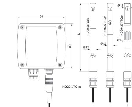
\* La lunghezza dello stelo dipende dalle grandezze misurate e dal tipo di sonda (in mm)
