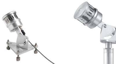
Prima di orientare l'eliofanometro nella posizione finale, posizionarlo verticalmente e regolare i piedini della base (per installazione su un piano) o del supporto (per installazione su palo Ø 40 mm) in modo che la livella posta nella parte superiore dello strumento sia perfettamente in piano.
